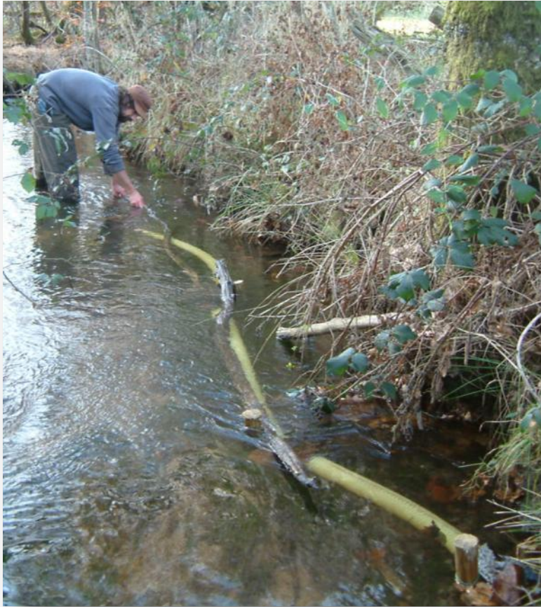
Essai de filtration avec un drain agricole
