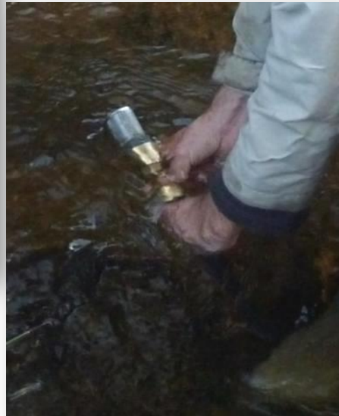
Essai de filtration avec une crépine du commerce
